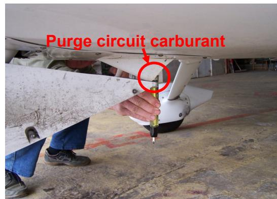
Purger les deux réservoirs et le circuit carburant. Vérifier le contenu entre chaque purge.
